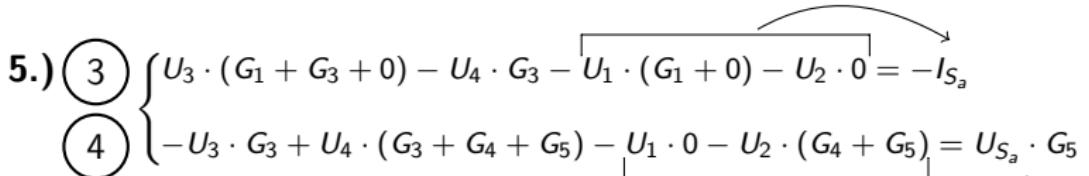
$$\begin{cases} 3: U_3 \cdot (G_1 + G_3 + 0) - U_4 \cdot G_3 - \underbrace{U_1 \cdot (G_1 + 0) - U_2 \cdot 0}_{= -I_{S_a}} = -I_{S_a} \\ 4: -U_3 \cdot G_3 + U_4 \cdot (G_3 + G_4 + G_5) - \underbrace{U_1 \cdot 0 - U_2 \cdot (G_4 + G_5)}_{= U_{S_a} \cdot G_5} = U_{S_a} \cdot G_5 \end{cases}$$
