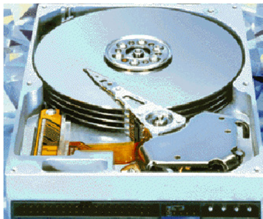
Figura 1.1: Mecânica elementar de um Disco Rígido.
