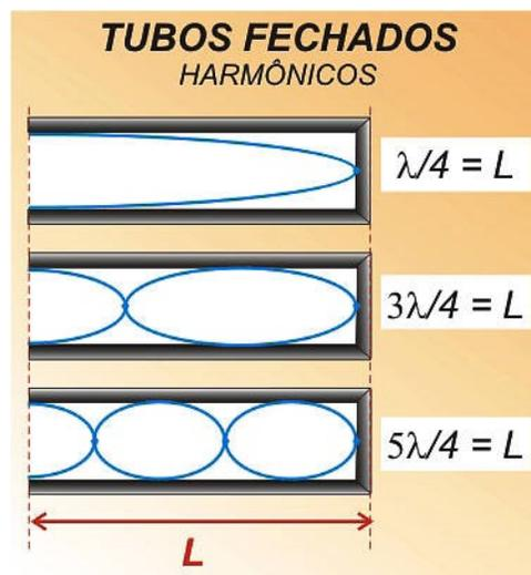
**Figura 2:** Onda Estacionária dentro de um Tubo Fechado. 1º, 2º e 3º Harmônico.
