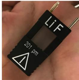
Figure 14: Celda de fluoruro de litio
